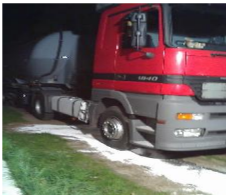
Auslaufender Kraftstoff wurde gebunden und das Erdreich abgetragen.
